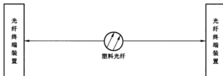
图 1 点到点通信结构组成示意图
